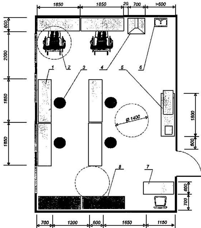
1 - верстак столярный; 2 - рабочее место инвалида; 3 - табурет с регулируемым сиденьем; 4 - стол с вытяжкой; 5 - верстак с деревообрабатывающим станком и циркулярной пилой; 6 - мойка; 7 - стол мастера; 8 - стеллаж производственный
